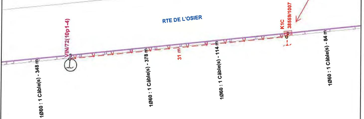
Poser chambre K1C sur câble enterré sur dérivation situé à environ 31m du PC VIN/72(10p1-4)
